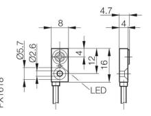
Induktiver Näherungsschalter BES R04KC-NOC15B-EV02 8 x 16 x 4 Öffner Sn=1,5mm bündig einbaubar
